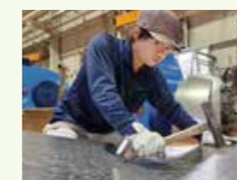
打ち出し板金作業
